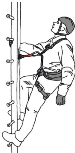
Se não houver um sistema de segurança estável e a estrutura precisar de ser escalada repetidamente, pode ser necessária uma linha de bloqueio de queda flexível.
