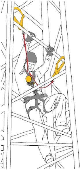
**Retenção de queda**, em caso de risco de queda, mesmo por um curto período de tempo, e necessário tomar medidas para a evitar, geralmente situações em que o técnico se movimenta em estruturas, necessitando apenas de um ponto de ligação. A queda pode ser evitada ou a força de impacto pode ser baixada para um nível aceitável (6 kN) usando um absorvedor de queda adequado.
