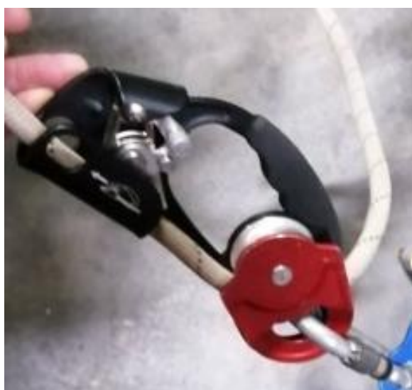
Figura 15 – Sistema anti-retorno com bloqueador (CNFGRIMP)
