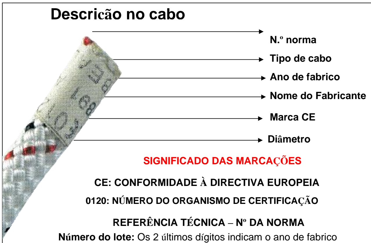
Figura 22: Identificação cabo (Beal 2014)
