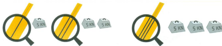
Figura 23: Marcações nas fitas EN 565
