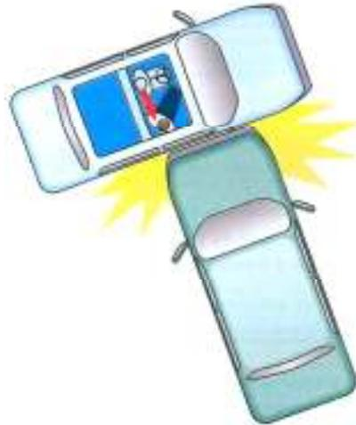
Fig. 26.13. O impacto lateral do veículo empurra todo o veículo contra o ocupante que não tenha o cinto de segurança colocado. O ocupante move-se lateralmente junto com o veículo.
