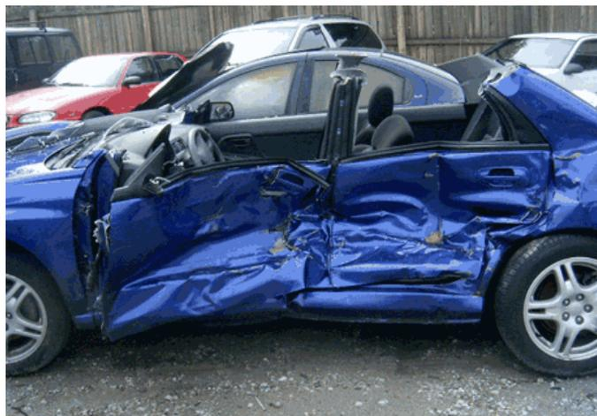
*Fig. 26.17. A intrusão da lateral do veículo no compartimento do passageiro é mais uma causa de lesão.*
